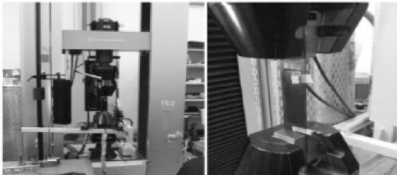
<그림 8> FRP-FBG 스트립 내공변위 센서의 검증 광경
